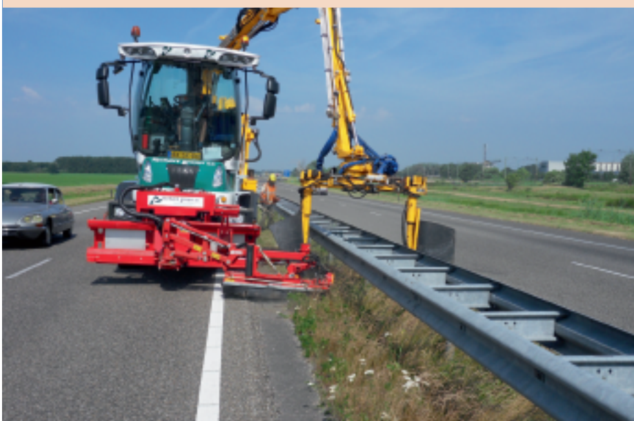
Met een zogenaamde hovercraft wordt het gras onder de vangrails gemaaid. Bij het door Verhart zelf ontwikkelde voertuig is de cabine afkomstig van een hakselaar en de opbouw van een vrachtwagen.
