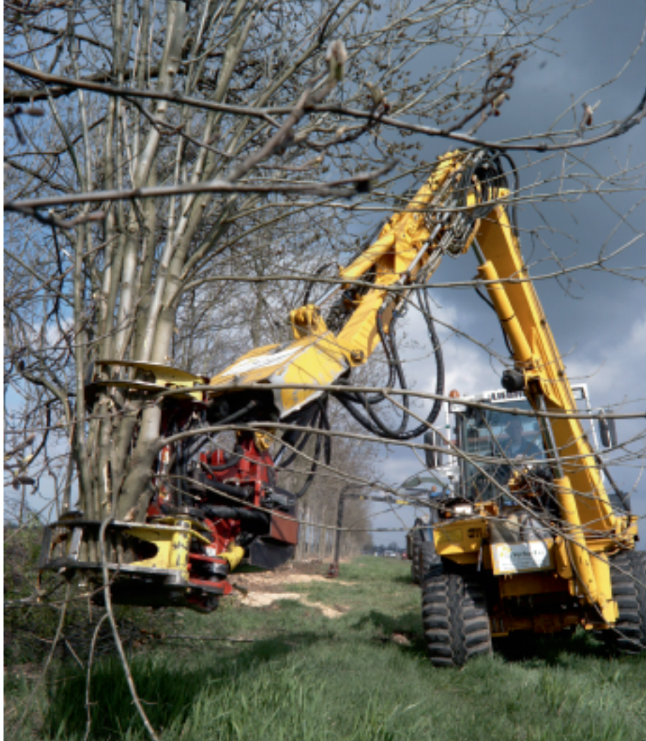
De machinale zaagklem-verzamelschaar is afkomstig uit Zweden en kan worden uitgevoerd met een mes of kettingzaag.
